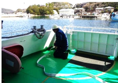
消火ホース設置
